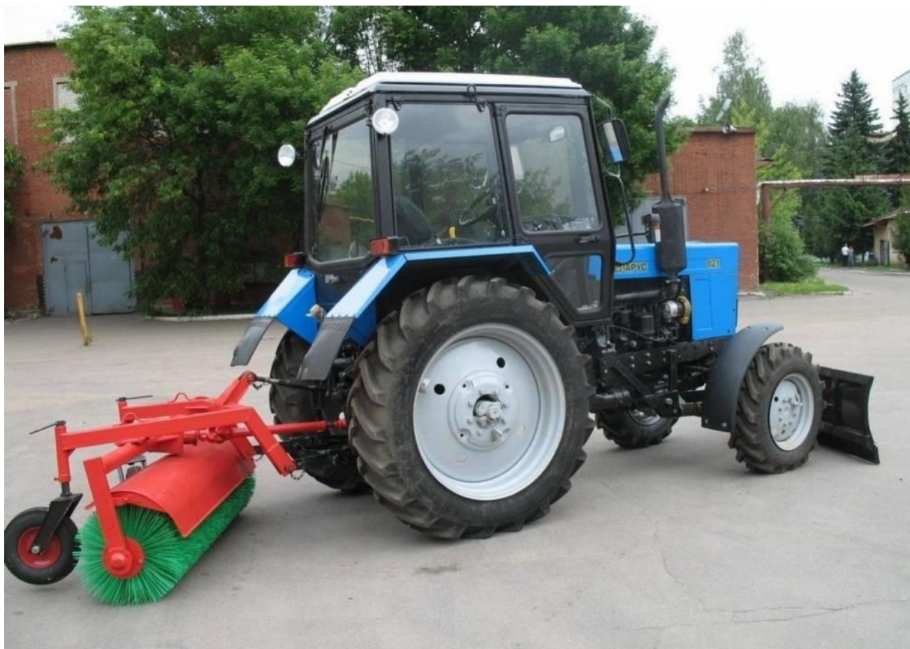
Общий вид щеточного оборудования
